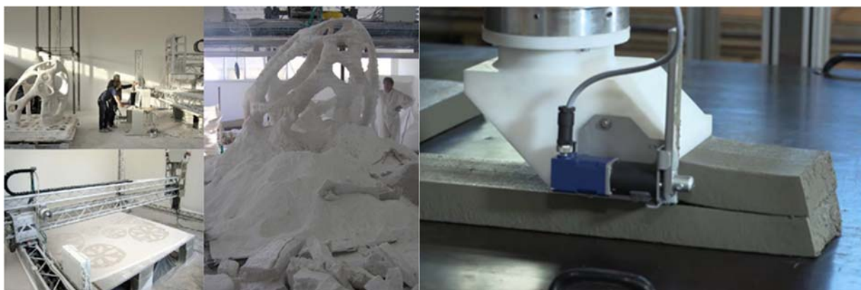
Figur 13: vänster skrivning i pulverbädd (Bild: E. Dini https://d-shape.com/ ) höger betongutskrift i lager (Bild Mechtcherine- TU Dresden)
