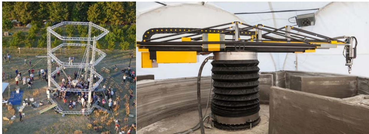
Figur 14: vänster WASP Delta printer ( https://www.3dwasp.com/ ) höger Apis Cor betong 3D skrivare ( https://www.apis-cor.com/ )
